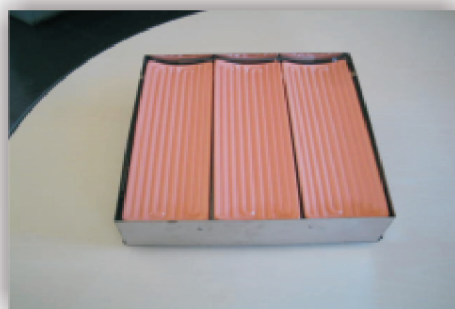
Caixa modular com isolamento térmico para Termoformadoras de grande porte.
