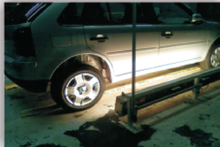
Secagem Infravermelho para pintura de automovel
